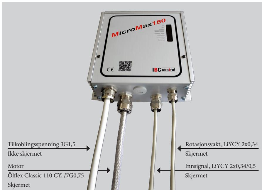
EMC-forskruing skal benyttes til skjermet kabel.
